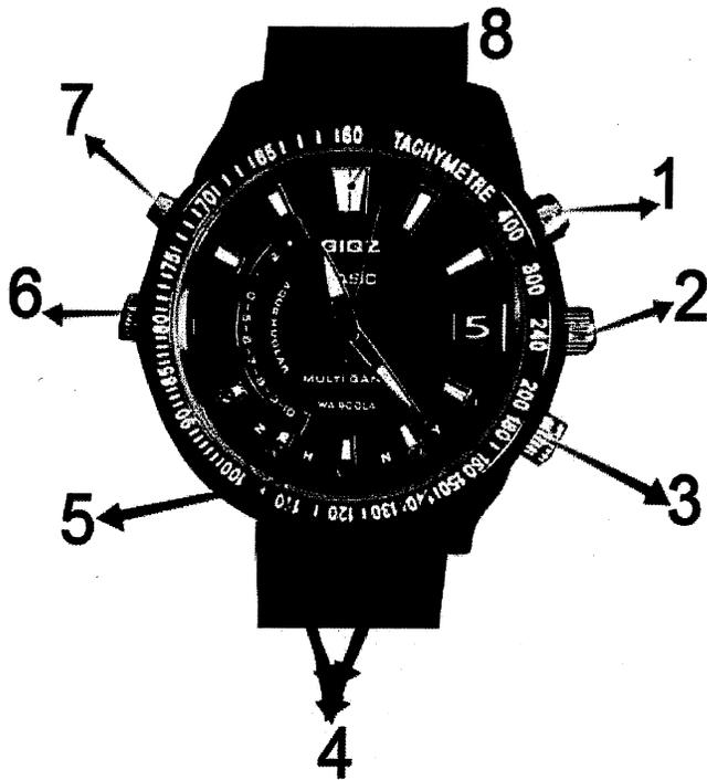
1. Bouton ON/OFF 2. Bouton de réglage de l'heure 3. Microphone 4. Infrarouge 5. Appareil photo 6. Port USB 7. Bouton Mode 8. Indicateur
